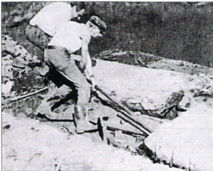
Les troueurs dégagent un bloc de marbre noir au fond de la carrière. (Photo Jean Leblois).
