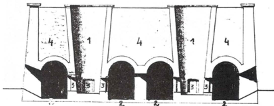
Sur la coupe on peut voir que le four est légèrement enterré et cela afin de faciliter la remontée de la chaux par un plan faiblement incliné. →
